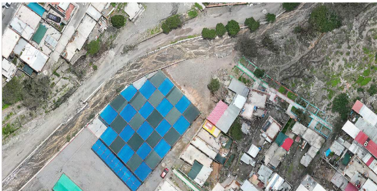
IMAGEN 03: EN ESTE TRAMO SE OBSERVA LA VISTA DE DRON, DONDE EL CAUCE DE LA QUEBRADA PASTORAIZ, SE ENCUENTRA COLMATADO, OCASIONANDO DAÑOS EN LA ESTRUCTURA DE CONCRETO ARMADO COLOCADO EN AMBAS MÁRGENES; DEBIDO A SU CRECIDA DE CAUDAL.
