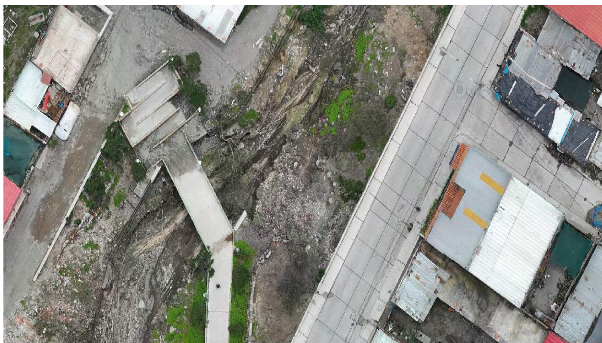
IMAGEN 02: EN ESTE TRAMO SE OBSERVA LA VISTA DE DRON, VIVIENDAS, Y VIAS, CERCANAS AL CAUCE DE LA QUEBRADA PASTORAIZ, DONDE SU CAJA HIDRÁULICA SE ENCUENTRA COLMATADO DE SEMIENTOS.
